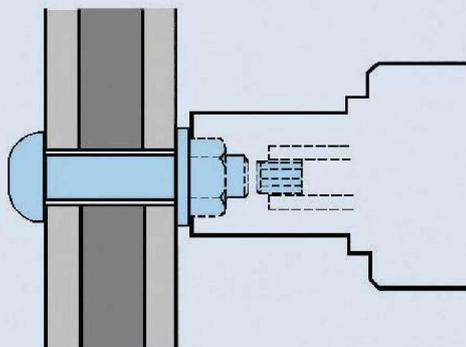
Pressez le bouton de démarrage. La douille extérieure tourne dans le sens horlogique et serre l'écrou. Lorsque la précontrainte correcte est atteinte, la douille extérieure s'arrête de tourner, la douille intérieure tourne à contre sens et rompt l'embout cannelé.
