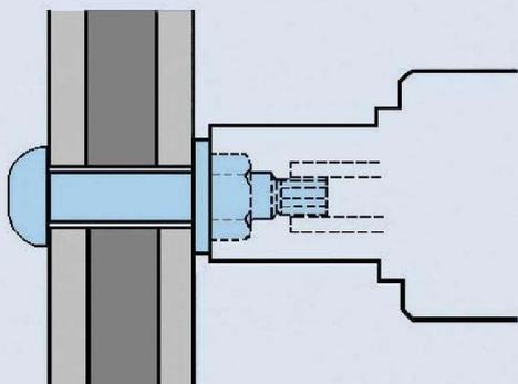
La douille intérieure de la boulonneuse à rupture s'adapte sur l'embout cannelé tandis que la douille extérieure s'adapte sur l'écrou.
