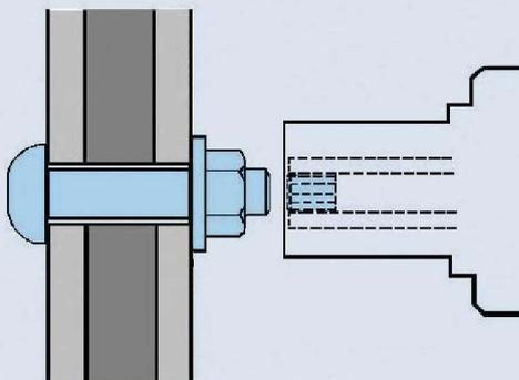
Arrêtez la boulonneuse et retirez la douille extérieure de l'écrou. L'embout cannelé est retenu dans la douille intérieure.
