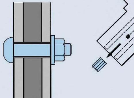
La boulonneuse possède une seconde gachette d'éjection de l'embout cannelé en toute sécurité. Le boulon est maintenant correctement installé avec la tension demandée.
